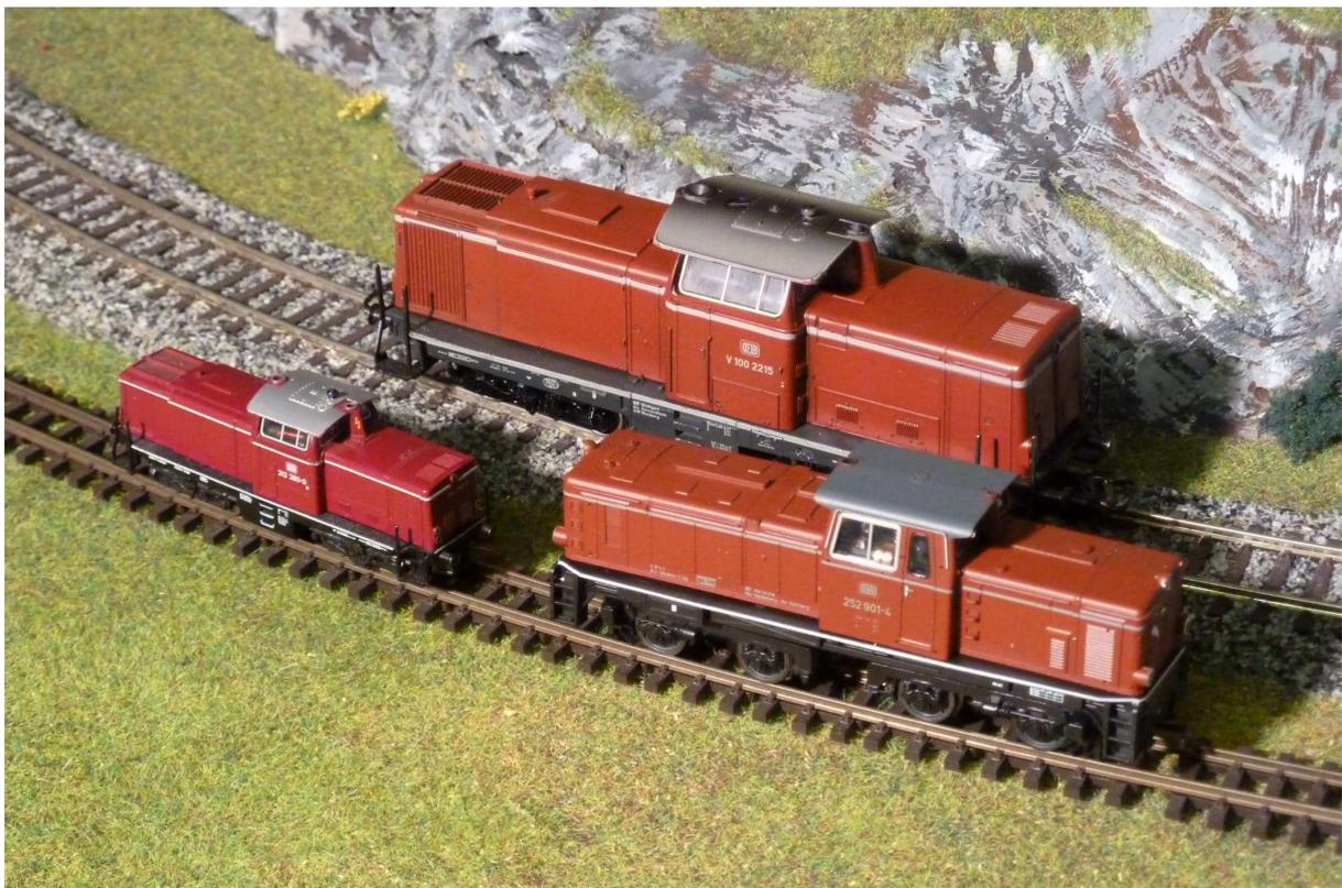
*Bild 11: vorne rechts die bekannte Gmeinder-Schmalspurlok der DB auf zugehörigem Modellgleis nach 750mm- Vorbild ( Spurweite 9 mm ), dahinter Vollspurgleis HO mit V- 100- Modell. Beide Loks repräsentieren den Maßstab 1: 87!. Ganz links zum Vergleich ein Spur- N- Modell der V 100, ebenfalls auf 9mm- Gleis, aber natürlich im Maßstab 1 : 160 gehalten!*
