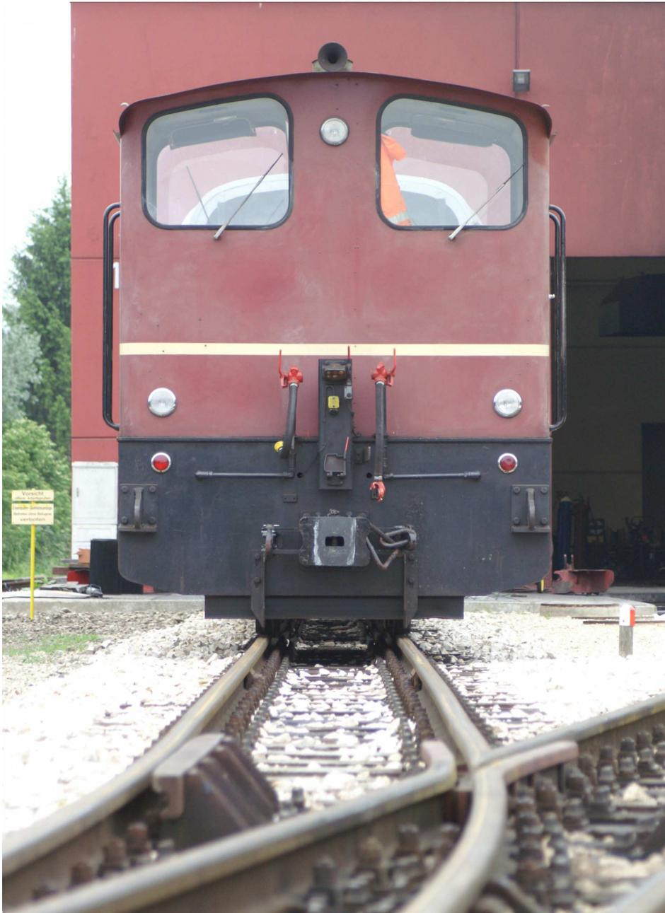
*Bild 5: Die V 22 beim Öchsle in Warthausen: Eine Normalspurlok auf Schmalspurgleisen von 750 mm Spurweite! ( Foto: Dr. Wolfgang Baierl )*
